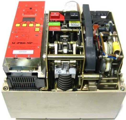
Ajuste o AC-PRO-MP™ no local e prensa usando os quatro (4) parafusos Phillips M3 X 16.
