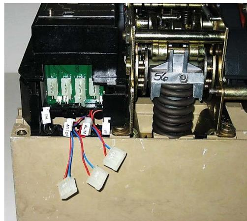
Desconecte os três (3) conectores de TC das fases. Desconecte o conector do TC do neutro, se aplicável. Desconecte os outros conectores. Identifique todos os conectores com uma etiqueta para evitar confusão.
