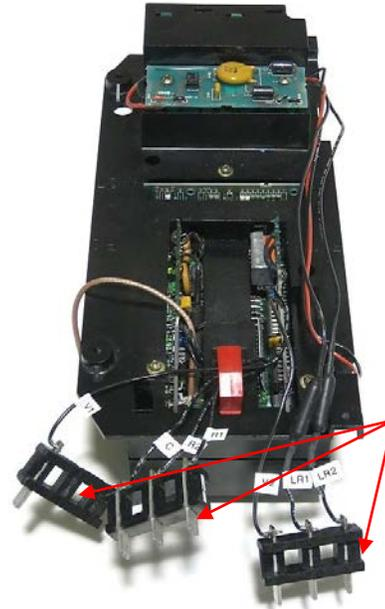
Desencaixe os conectores dos 3 blocos de terminais de plástico
